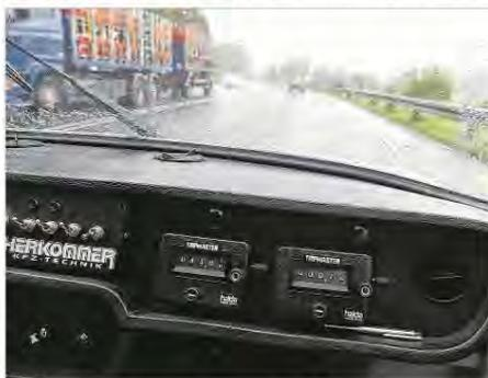
Der Arbeitsplatz des Beifahrers: zwei Tripmaster, die die Wegstrecke anzeigen und so das Navigieren nach dem „Roadbook“ ermöglichen.
